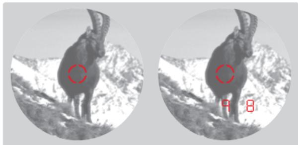
Per misurare la distanza di un oggetto, è necessario rilevarne esattamente la posizione. A tal fine, procedere nel modo seguente:
