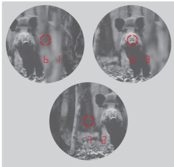
Con Leica Rangemaster è possibile eseguire misurazioni anche a ciclo continuo (modalità Scan):
